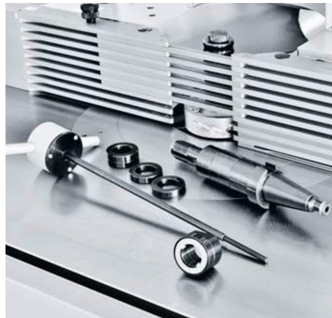
Système de changement du mandrin SK40 | Standard
